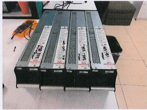
Cada módulo fue verificado posterior al remplazo de baterías para conformar que las conexiones realizadas eran correctas.
